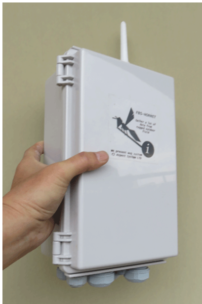
AD16ch+DI2ch 単2x8本内臓 屋外 Web 観測システム
