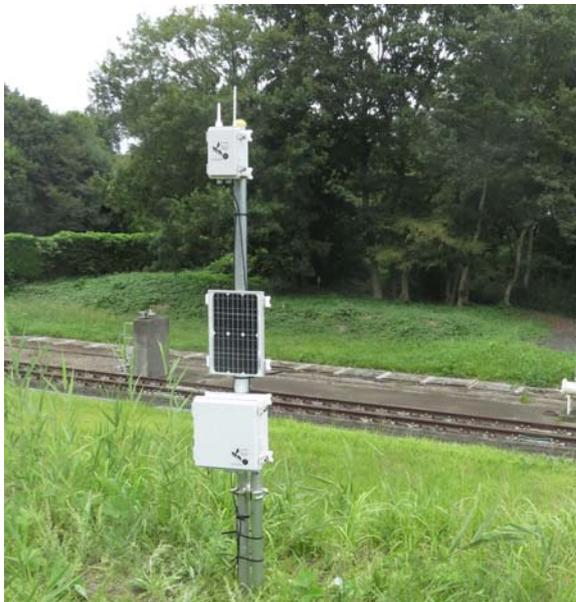
太陽電池駆動で常時動作のLoRa/3Gゲートウェイ動作に必要な全ての機器を2 mの単管を立てて設置 数ヶ月間運用しました。
