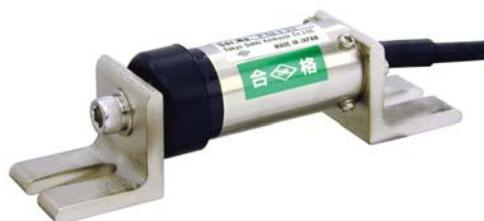
左は歪計のひとつ亀裂変位計ですが5V給電でuV出力ならロードセル・傾斜計・沈下計・伸縮計と様々なセンサを直接接続できます。外部電源や歪ゲージ用のアンプも不要で省電力でコスト削減にもなっています。
