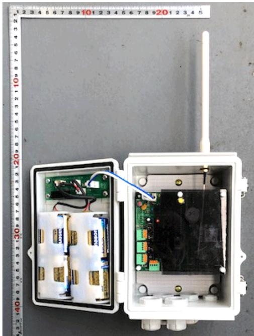
汎用6チャンネル(AD2ch+DI2ch)の観測に4ゲージ式歪計測が加わって詳細な評価を行っていました。
