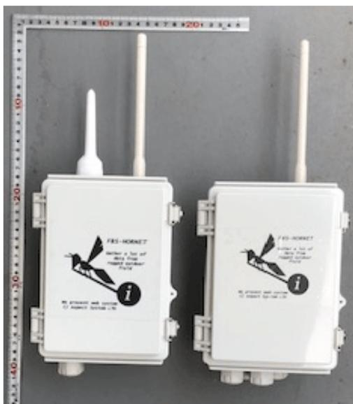
左がLoRa/3Gゲートウェイで右がLoRaの観測システムでLoRaは同じ周波数のグループで14台接続できます。
