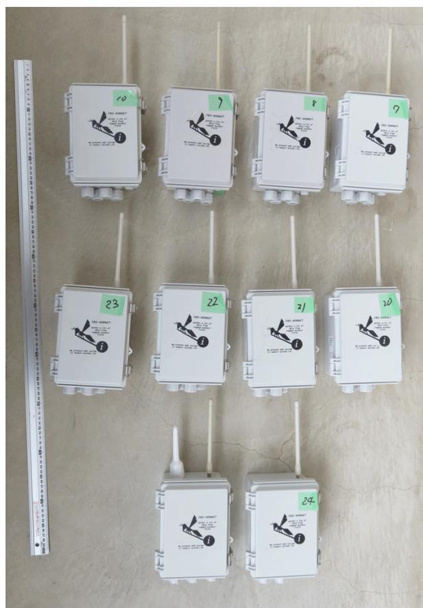
左のシステムは300m四方の工事現場で使用するLoRaノード9台とゲートウェイ1台で多地点観測するシステムです。
