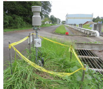
写真2 LoRa水位・雨量観測
