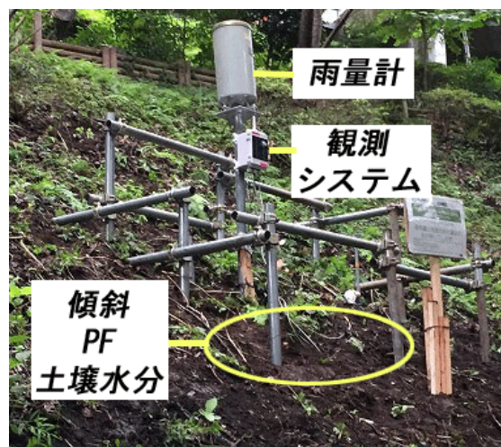
写真 1.1 斜面の雨量と斜面状況観測
