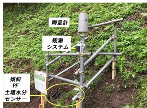
斜面の雨量・土壌水分・傾斜・吸引水頭の簡易観測
