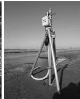
乾電池駆動 FOMA3G 水位観測システム
