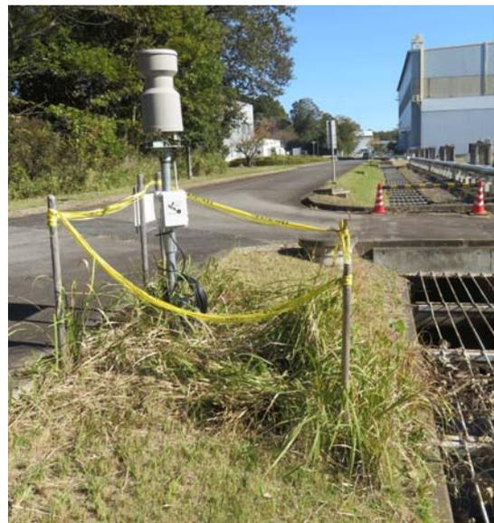
雨量と水位を3分毎計測、送信で 4 ヶ月内蔵の電池で連続観測中のの LoRa 観測ノード
