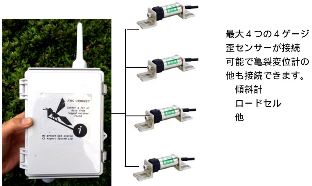
「手に乗るWeb観測点」+ 4つの亀裂変位センサー
